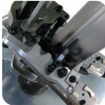
special design avoidance abrasive belt loose 特殊磨刀器設計 有效避免脫帶
